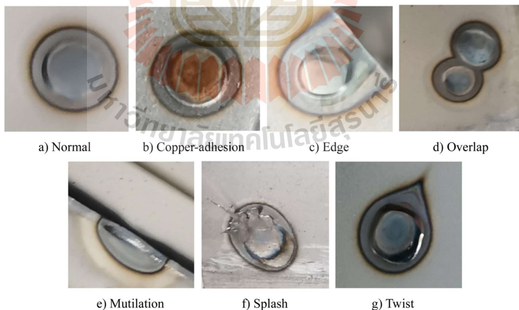
รูปที่ 2.47 หมวดหมู่ของภาพลักษณะรอยเชื่อม RSW [79]
