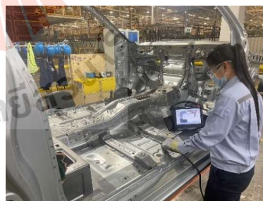
รูปที่ 1.5 การตรวจสอบแบบ UT
