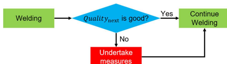
รูปที่ 2.49 กระบวนการทำงานของการเชื่อมพร้อมการทำนายคุณภาพ [58]
