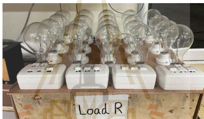
รูปที่ 8.8 ชุดหลอดไฟแทนโหลดตัวต้านทาน
