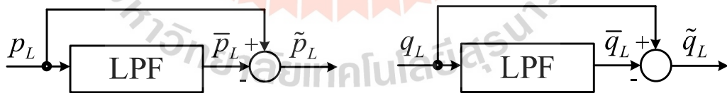
รูปที่ 3.11 การใช้วงจร LPF ในการแยกองค์ประกอบฮาร์มอนิกของกำลังไฟฟ้าสลับ ( p', q' )
