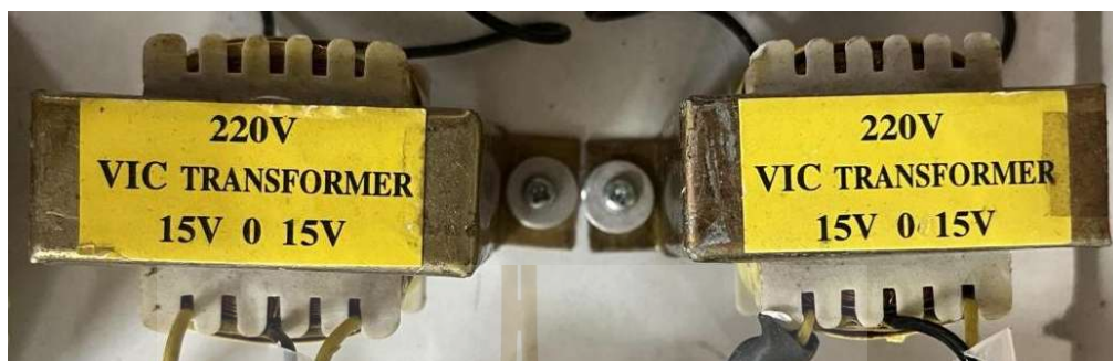
รูปที่ 8.14 หม้อแปลงแท่งปกลางสำหรับตรวจวัดแรงดันไฟฟ้า
