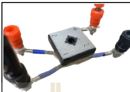
รูปที่ 6.5 มอดูลวงจรเรียงกระแสแบบบริดจ์หนึ่งเฟส GBPC35
