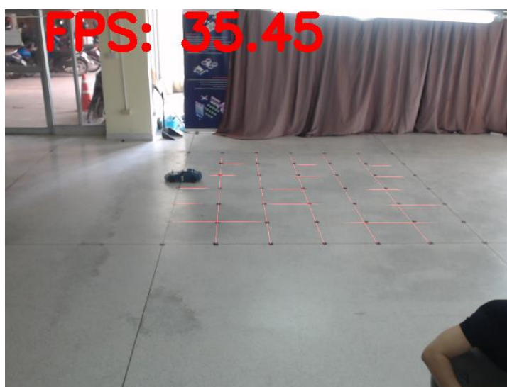
รูปที่ 3.9 เป็นการแปลงรูปภาพ Inverse Perspective Mapping
