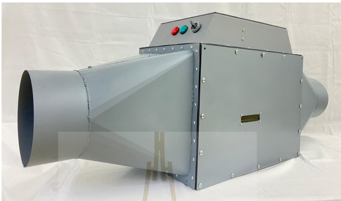
รูปที่ 3.14 เครื่องที่ใช้ในการทดสอบสลายตัวของคาร์บอนไดออกไซด์
