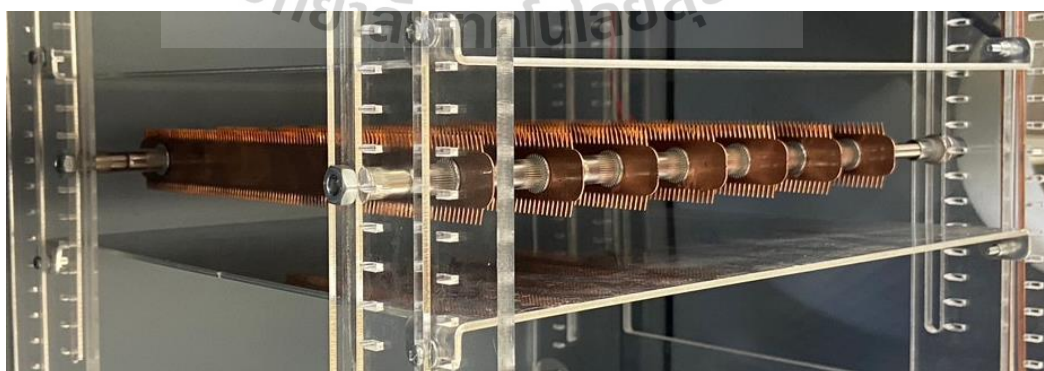
รูปที่ 3.9 การติดตั้งอิเล็กโทรดรูปแบบปลายแหลมกับแผ่นเพลทที่ใช้เป็นกราวด์ ก) อิเล็กโทรดรูปแบบปลายแหลมที่ออกแบบ ข) ตัวอย่างการติดตั้งใช้งานจริง
