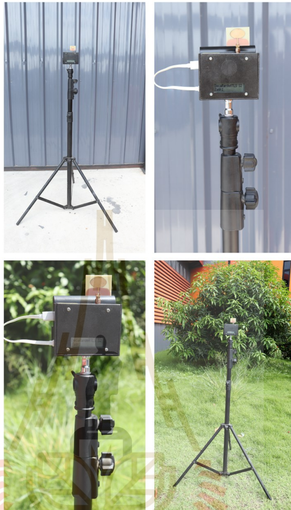
รูปที่ 3.18 การติดตั้งอุปกรณ์โหนด Ultra Wideband ณ พื้นที่การปฏิบัติการของรถบรรทุกขับเคลื่อนอัตโนมัติ
