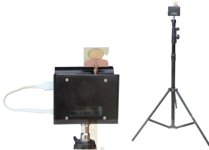
รูปที่ 3.16 อุปกรณ์โหนด Ultra Wideband ที่ได้รับการสร้างขึ้นจากแผงวงจร EVB1000
