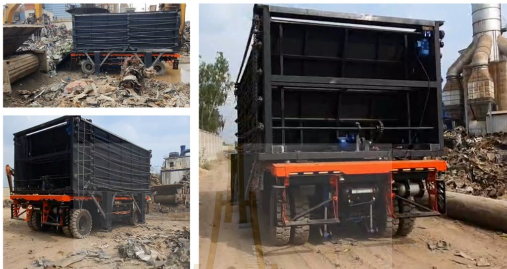
รูปที่ 3.10 กระบะสำหรับบรรทุกภาระ ติดตั้งเข้ากับรถบรรทุกอัตโนมัติโดยการยกตัวและย่อตัวของรถ
