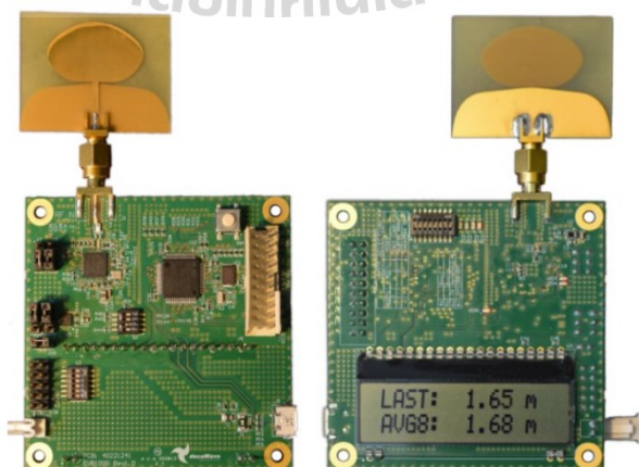
รูปที่ 3.13 รูปร่างของแผงวงจรรุ่น EVB1000 แสดงทั้งด้านหน้าและด้านหลัง
