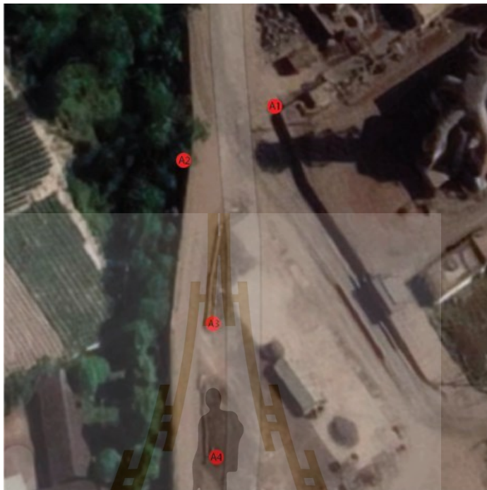
รูปที่ 3.12 การติดตั้งโหนด Ultra Wideband จำนวน 4 โหนดในพื้นที่นำร่องที่เป็นสถานที่ปฏิบัติงานจริงที่โรงงาน บริษัท มิลล์คอน บุรพา จำกัด
