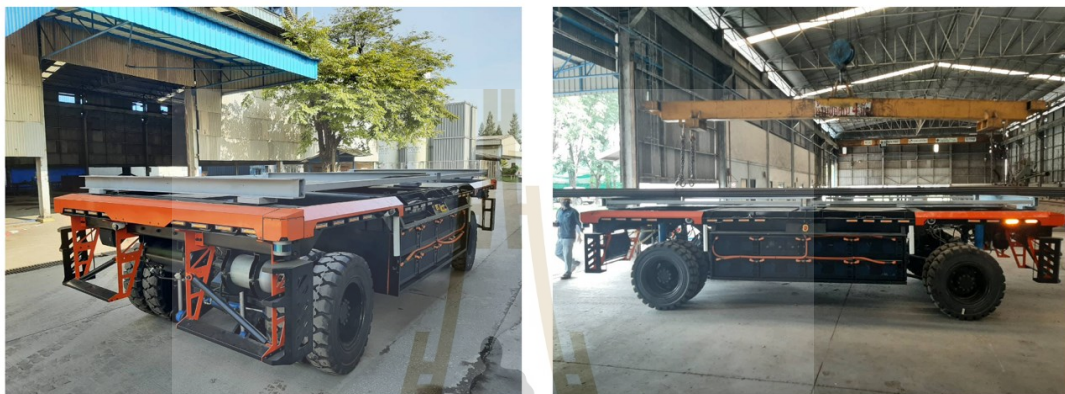
รูปที่ 3.6 รถบรรทุกขับเคลื่อนอัตโนมัติแสดงแผงชั่งน้ำหนัก และการขนภาระภายในพื้นที่ของโรงงาน บริษัท มิลล์คอน บุรพา จำกัด โดยไม่ได้ติดตั้งกระบะ
