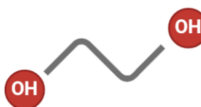
รูปที่ 2.3 มอนอเมอร์ชนิดไดออลที่ส่วนประกอบจากกลุ่มไฮดรอกซิล
