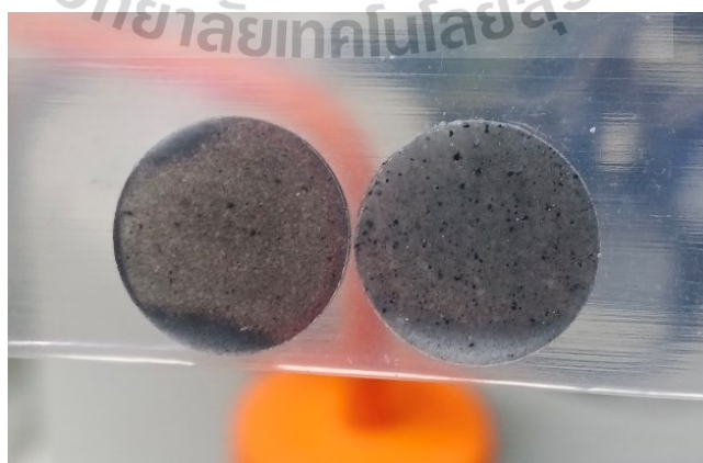
รูปที่ 3.13 การเตรียมตัวอย่างถ่าน MAC ที่ใช้ในการวิเคราะห์ FTIR แบบส่องผ่าน
