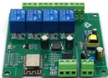
รูปที่ 3.6 บอร์ดควบคุม Relay ยี่ห้อ/รุ่น DIYMore ESP-12F
