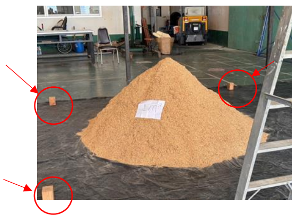
รูปที่ 3.11 จุดควบคุมภาคพื้น (Ground control point) รูปทรงสี่เหลี่ยม
