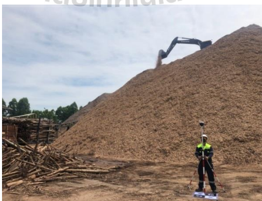
รูปที่ 2.6 การทำหมุดอ้างอิงตำแหน่ง (GCP)
