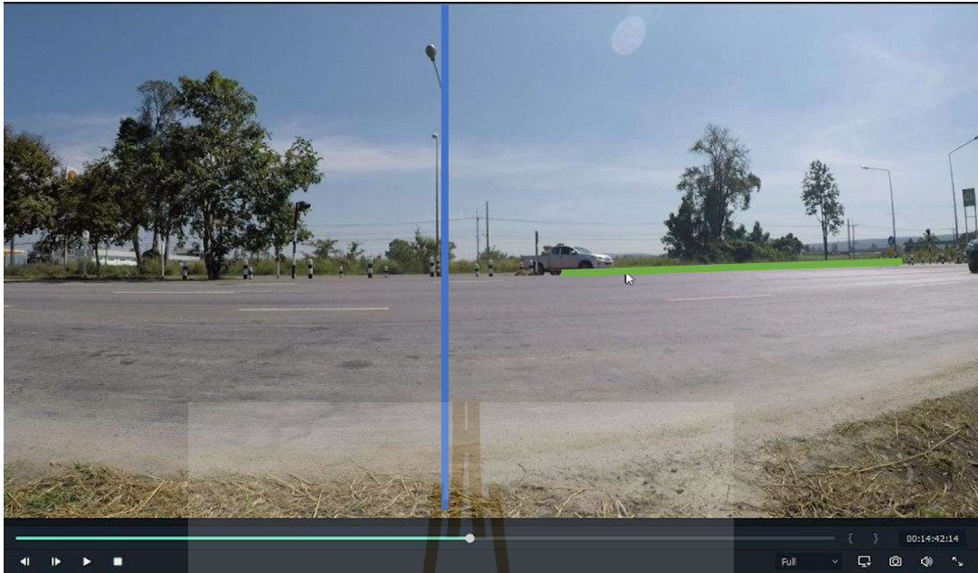
รูปที่ 3.3 เส้นแนวอ้างอิงทั้ง 2 เส้นจากการเก็บข้อมูลด้วยวิดีโอ
