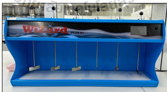
รูปที่ 3.13 เครื่อง Jar test ยี่ห้อ Wizard รุ่น PLUS 6 LED ประเทศเยอรมัน
