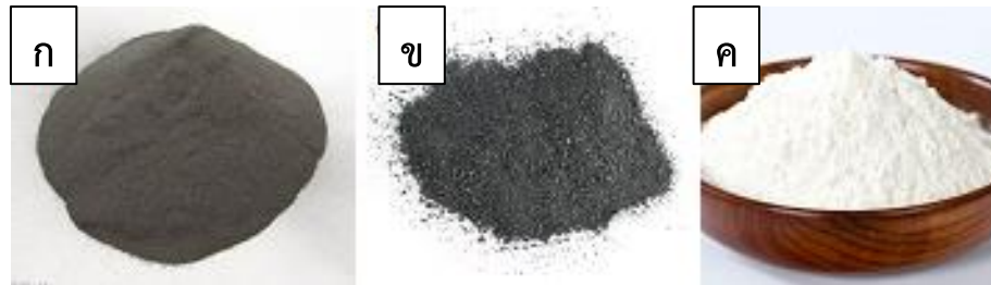
รูปที่ 3.1 ตัวอย่างของผสมที่ใช้ในการเตรียมชิ้นงานเผาผนึก (ก) ผงโลหะ pre-alloyed (Astaloy Mo) (ข) ผงซิลิคอนคาร์ไบด์ (SiC powder) และ (ค) ผงซิงค์สเตียเรท (Zinc stearate)
