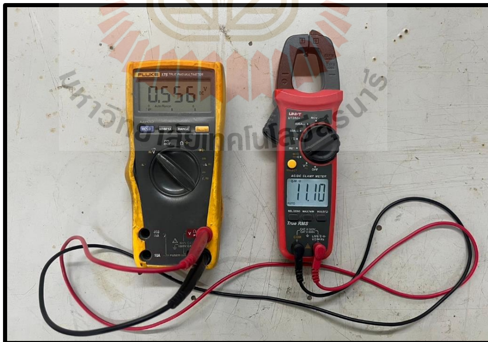
รูปที่ 4.2 วัดค่าความต้านทานภายใน Digital Multimeter (DMM)
