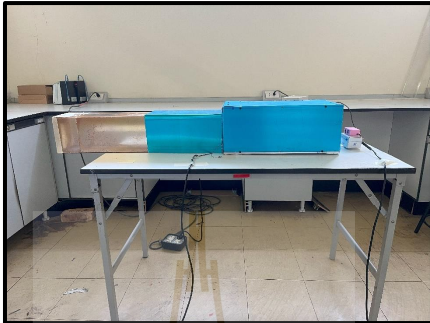
รูปที่ 4.15 การทดลองกำจัดฝุ่นด้วยระบบโคโรนาดีสชาร์จ
