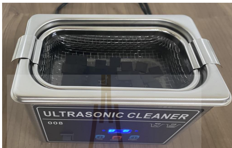
รูปที่ 3.5 การทำความสะอาดกราฟิต์ด้วยเครื่องอัลตราโซนิก
