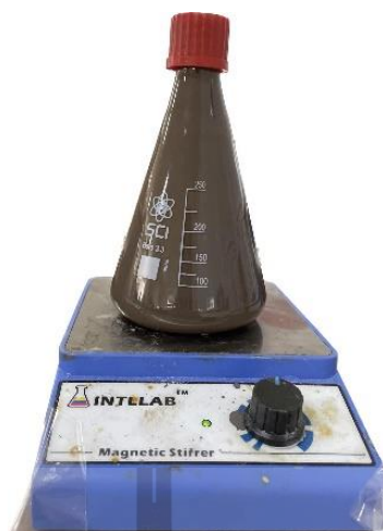
รูปที่ 3.6 การกวนสารละลายโดยใช้เครื่องกวนสารแบบแม่เหล็ก
