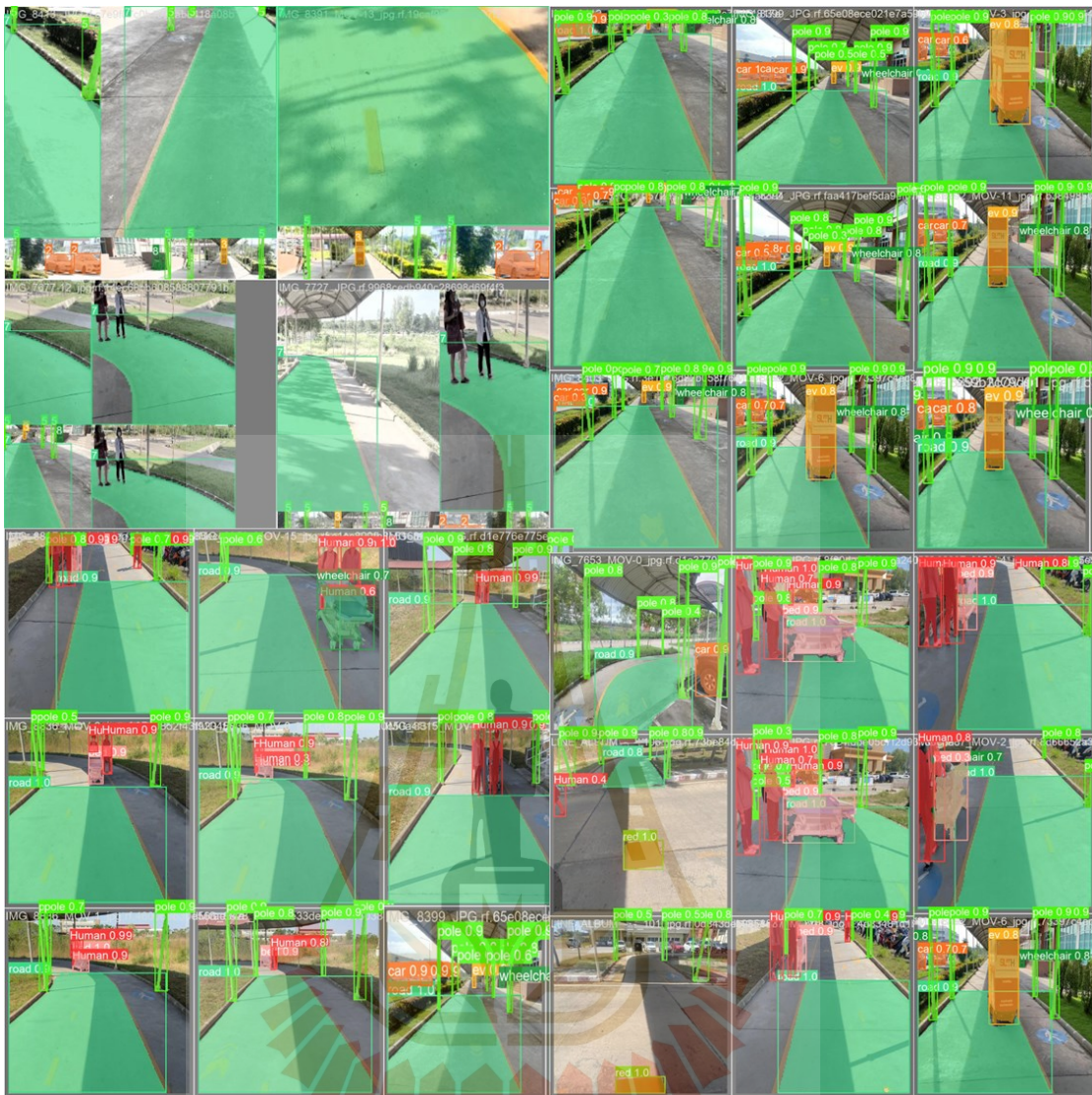
รูปที่ ก.4 ผลการตรวจจับภาพด้วยโมเดล YOLOv8I มหาวิทยาลัยเทคโนโลยีสุรนารี
