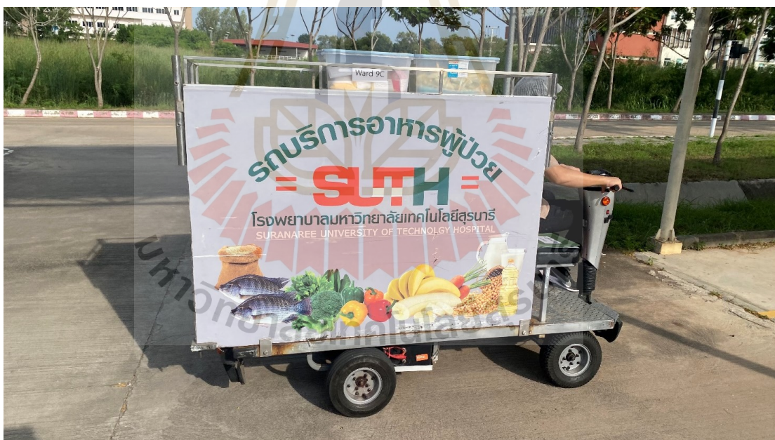
รูปที่ 1.1 รถไฟฟ้าแบบไร้คนขับขนส่งเวชภัณฑ์ของโรงพยาบาลมหาวิทยาลัยเทคโนโลยีสุรนารี
