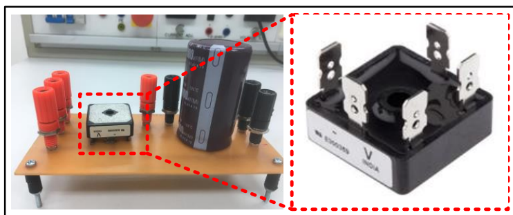
รูปที่ 7.7 มอดูลไดโอด 3 เฟส รุ่น VS-36MT160
