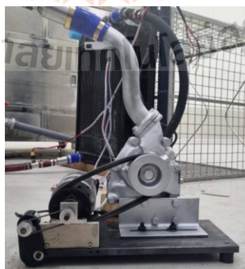
รูปที่ 3.4 ปั๊มน้ำและมอเตอร์
