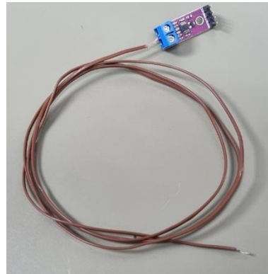
รูปที่ 3.9 K-type Thermocouple and amplifier module
