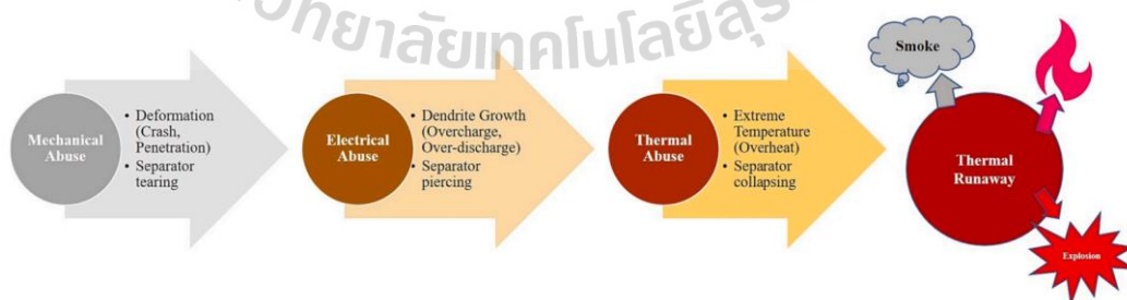
รูปที่ 1.2 กลไกการเกิด Thermal Runaway (TR) และปัจจัยที่มีผลกระทบ (Dusad et al., 2019)
