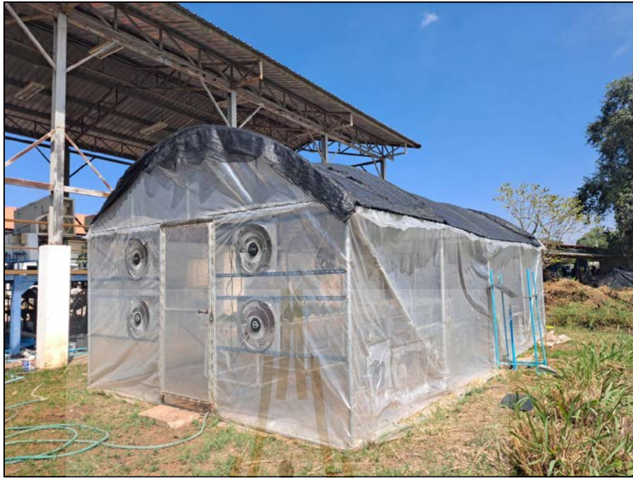
รูปที่ 3.1 โรงเรือนทดสอบระบบทำความเย็นแบบแผ่นระเหยน้ำ
