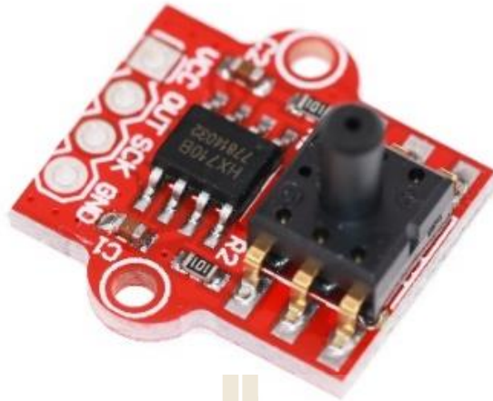
รูป 2.11 เซนเซอร์วัดความดันอากาศแรงดันน้ำ Liquid-Air Pressure Sensor Module 0-40kpa สำหรับ Arduino
