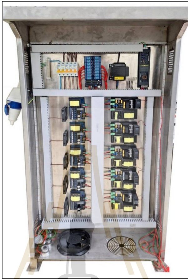
รูปที่ 3.3 แหล่งกำเนิดคลื่นเสียงความถี่สูงสำหรับสถานีหลัก
