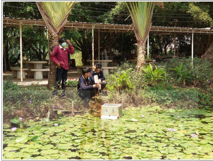
รูปที่ 4.11 รูปแบบการทดสอบการแพร่กระจายคลื่นเสียงความถี่สูงในบริเวณข้างแหล่งน้ำ สำหรับระบบกำจัดของจรรชีวิตยูงต้นแบบในแหล่งน้ำที่มีพืชน้ำหนาแน่น
