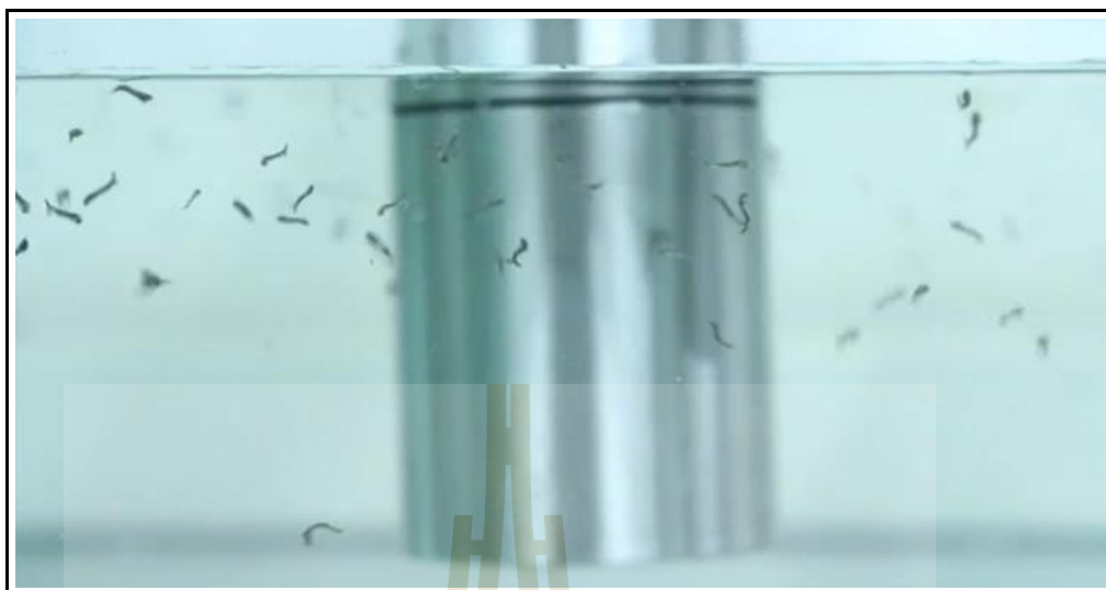
รูปที่ 3.65 ผลการทดสอบของเครื่องชูดปล่อยคลื่นเสียงความถี่สูงในบริเวณแหล่งน้ำสำหรับระบบกำจัดวงจรชีวิตยุงต้นแบบในห้องปฏิบัติการ
