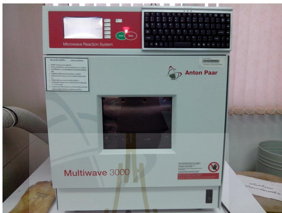
รูปที่ ค.1 Microwave Digestion (Anton Paar Multiwave 3000)
