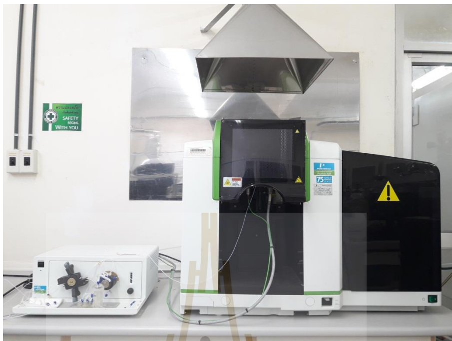
รูปที่ ค.3 Hydride Generation Atomic Absorption Spectroscopy (PerkinElmer - PinAAcle 900F)
