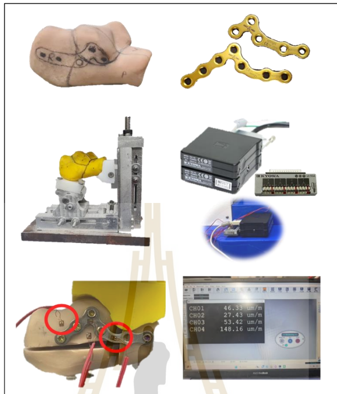
รูปที่ 3.16 ภาพแสดงอุปกรณ์ต่างๆ ที่ใช้ในการทดสอบทางกล
