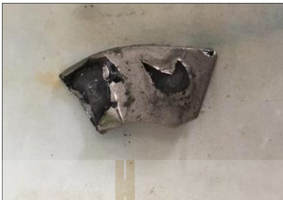
รูปที่ 4.6 แม่เหล็กที่ไม่สามารถชะละลายได้หมดก่อนที่จะทำการบดเพื่อลดขนาด
