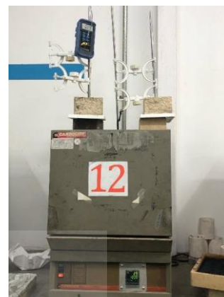
รูปที่ 3.9 ขั้นตอนการเผาตะกอนของแข็ง a, b วางเข้าเซรามิกในเตาเผา c, d ติดตั้งชุดเทอร์โมคัปเปิล
