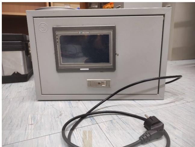
รูปที่ 3.18 เครื่องทดสอบการทำงานของตู้ควบคุมไฟถนนฯ
