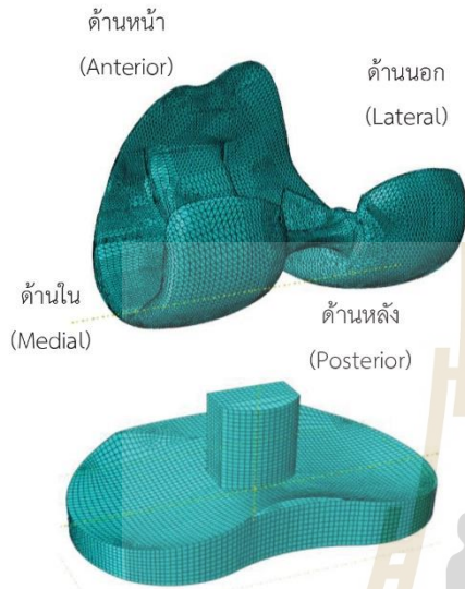
รูปที่ 2 แบบจำลองไฟไนต์เอลิเมนต์ของข้อเข่าเทียมประเภทตัดเอ็นไขว้หลัง ผาครอบกระดูกต้นขาส่วนปลาย (บน) หมอนรองข้อเข่าเทียม (ล่าง)
