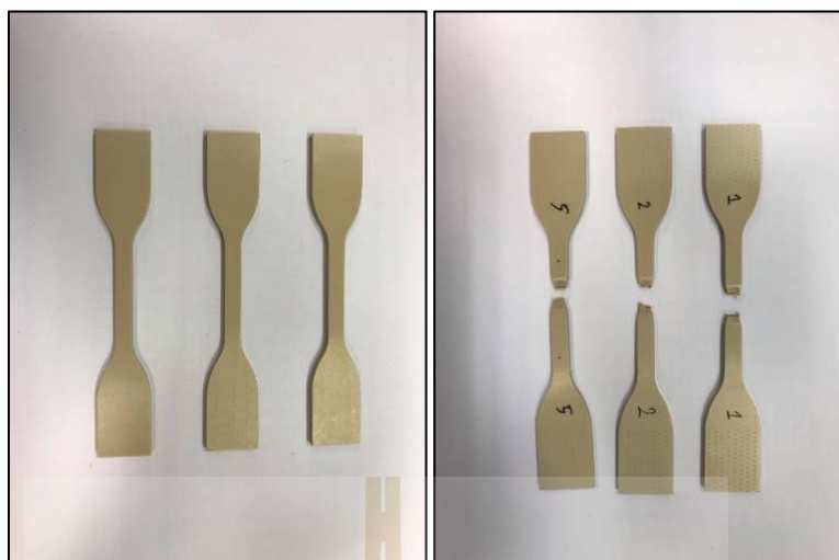
รูปที่ 4.4 วัสดุโพลีเอเทอร์เอเทอร์คีโตน (ซ้าย) ก่อนทดสอบ (ขวา) หลังการทดสอบ
