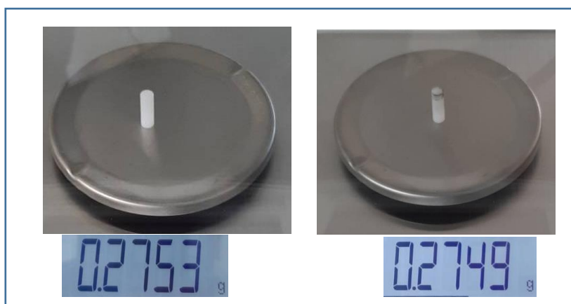
รูปที่ 4.5 น้ำหนักของพินวัสดุโพลีเอทิลีนน้ำหนักโมเลกุลสูง (ซ้าย) ก่อนการทดสอบ (ขวา) หลังจกการทดสอบ
