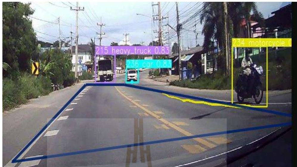
รูปที่ 4.7 ตัวอย่างผลลัพธ์ของโมเดลจำแนกประเภทและรูปแบบการเคลื่อนที่ของยานพาหนะ F) กรอบพื้นที่คลาดเคลื่อนจากขอบเขตช่องจราจรที่สนใจ
