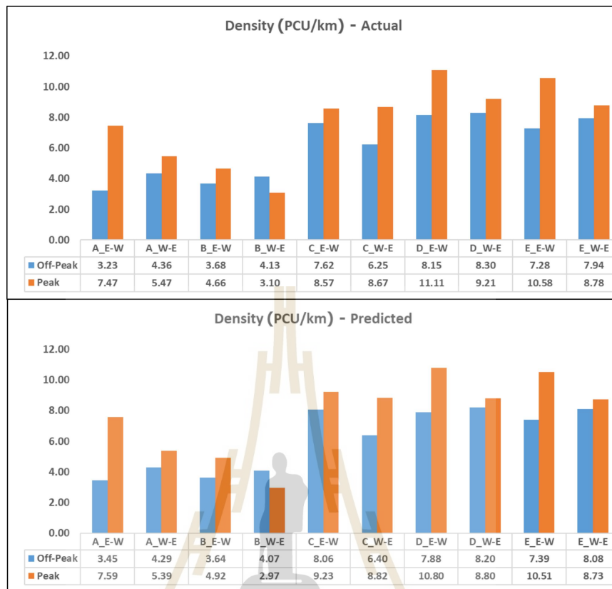
รูปที่ 4.29 ผลการเปรียบเทียบค่าความหนาแน่นจราจรในแต่ละช่วงเวลาสำรวจ
