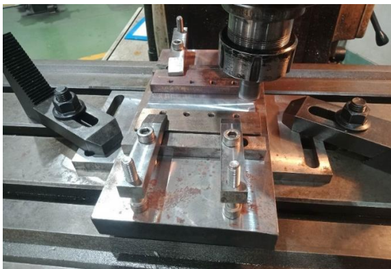
รูปที่ 3.5 การติดตั้งอุปกรณ์จับยึดบนเครื่องกัด
