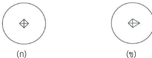
รูปที่ 2.4 ลักษณะรอยกุดของหัวกดวิกเกอร์
