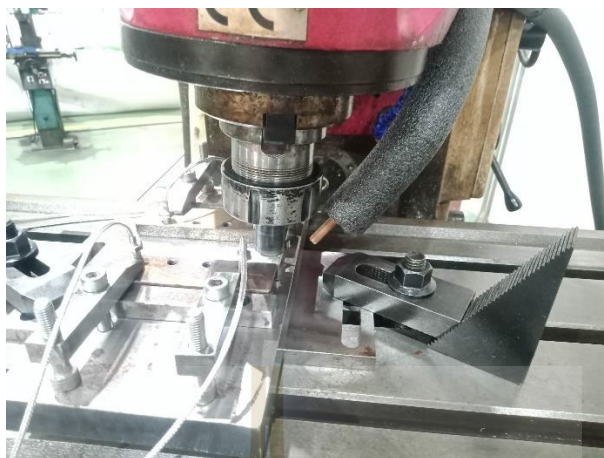
รูปที่ 3.9 การติดตั้งระบบหล่อเย็นด้วยไครโอเจนิคส์
