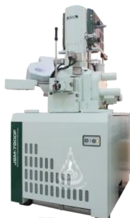
รูปที่ 3.7 เครื่องมือ Scanning Electron Microscope (SEM)
