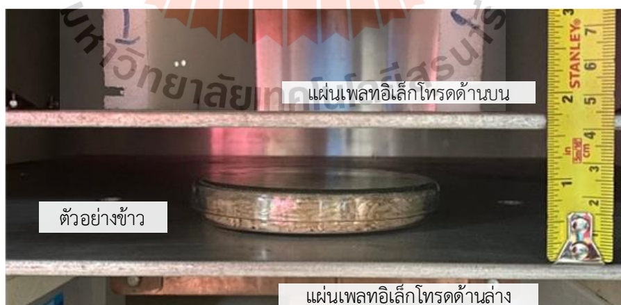
ค) ที่ความเข้มสนามไฟฟ้า 225 kV/m
