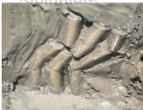
รูปที่ 2.29 การวิบัติของแท่งดินซีเมนต์ (นิธิ,2554)
