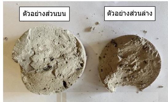
รูปที่ 4.5 การวิบัติของรอยต่อที่เว้นช่วงเวลาก่อสร้าง 0 ชั่วโมง
