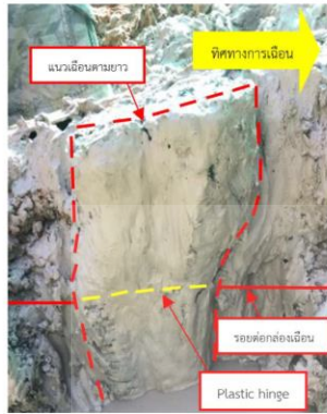
รูปที่ 17 รูปแบบการวิบัติแบบของเสาเข็มดินซีเมนต์รับแรงดันข้าง แบบ 2SCC-S24 เป็นแบบ shear failure along column และเกิด plastic hinge
