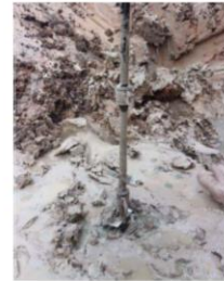
2. ผสมดินโดยกดก้านและจุ่มในแนวตั้ง หมุนก้านจะตามเข็มนาฬิกาจากนั้น ถอดก้านจะซีโดยหมุนก้านเข็มนาฬิกา
