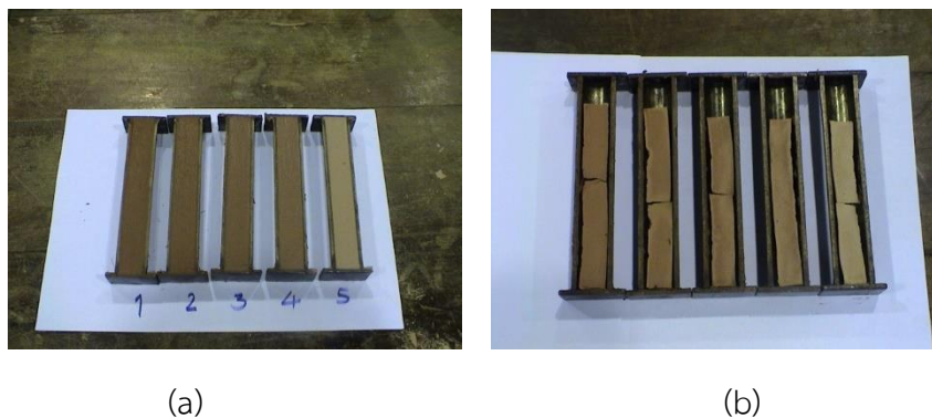
รูปที่ 3.7 การทดสอบการหดตัวเชิงเส้น (a) ก่อนการหดตัว (b) หลังสิ้นสุดการหดตัว
