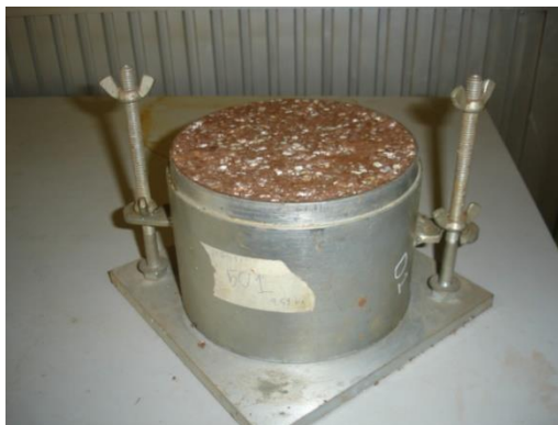
รูปที่ 3.8 ตัวอย่างดินบดอัด WH-50 ก่อนการติดตั้งเสาเข็มเหล็ก
