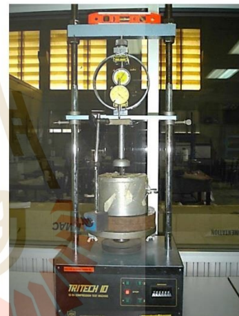
รูปที่ 10 ภาพถ่ายการทดสอบกำลังต้านทานแรงเฉือนที่ผิวแห้งเหล็กในตัวอย่างที่ปล่อยให้ระเหยในอุณหภูมิห้อง
