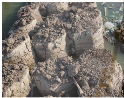
รูปที่ 10 การแยกจากกันของ SCC บริเวณรอยต่อระหว่างต้นเมื่อเกิดการวิบัติ
