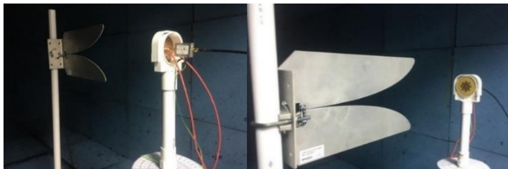
(ค) ภาพถ่ายการติดตั้งจริงของการวัดทดสอบแบบรูปการแผ่กำลัง รูปที่ 5.5 การติดตั้งการวัดของสายอากาศ
