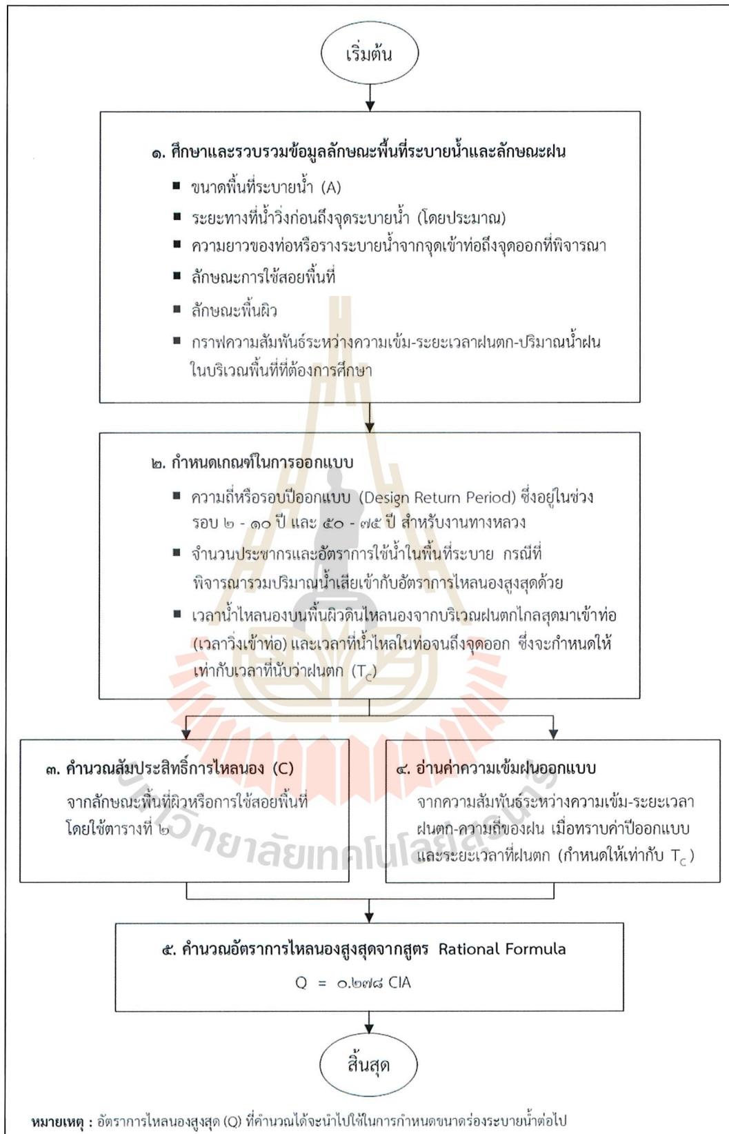
รูปที่ 4.24 แผนภูมิแสดงขั้นตอนการคำนวณอัตราการไหลนองสูงสุด (Q)
