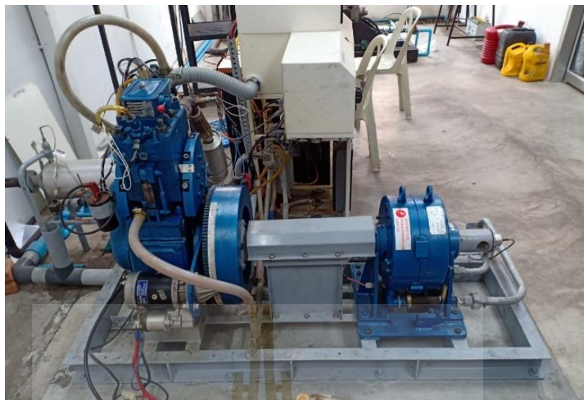
รูปที่ 3.10 เครื่องยนต์ดีเซลสูบเดี่ยวแบบแปรผันอัตราส่วนกำลังอัดที่ใช้ในการทดสอบ
