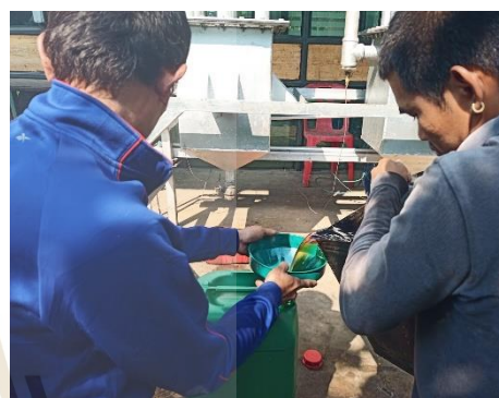
รูปที่ 3.6 การผลิตน้ำมันขยะพลาสติกด้วยเครื่องปฏิกรณ์ไฟโรไลซิส แบบเบดคงที่ (Fixed-Bed Reactors) ขนาดกำลังการผลิต 100 กิโลกรัมต่อครั้ง
