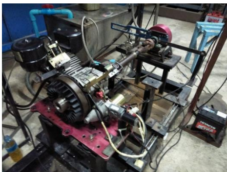
รูปที่ 3.17 การติดตั้งเครื่องยนต์ดีเซลสูบเดี่ยวทางการเกษตรเข้ากับไดนาโมมิเตอร์
