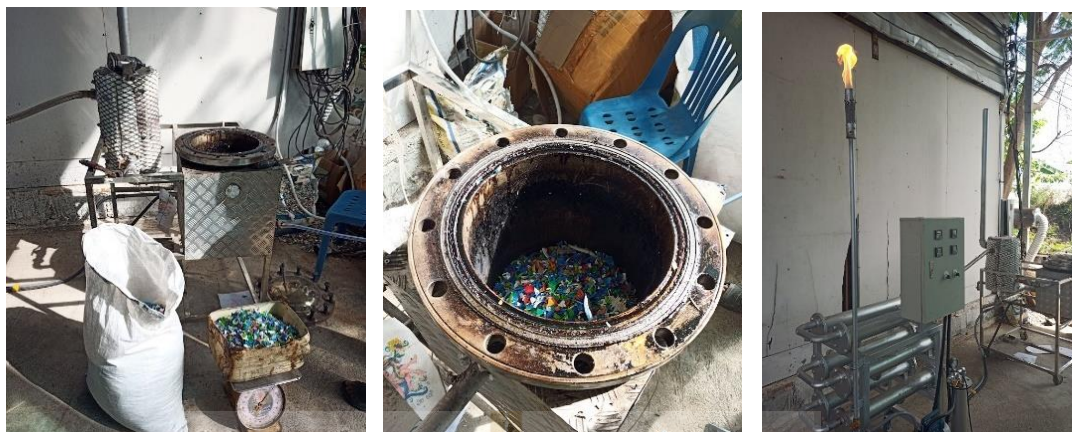
รูปที่ 3.5 การผลิตน้ำมันขยะพลาสติกด้วยเครื่องปฏิกรณ์ไพโรไลซิส แบบเบดคงที่ (Fixed-Bed Reactors) ขนาดเล็ก
