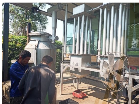
รูปที่ 3.6 การผลิตน้ำมันขยะพลาสติกด้วยเครื่องปฏิกรณ์ไฟโรไลซิส แบบเบดคงที่ (Fixed-Bed Reactors) ขนาดกำลังการผลิต 100 กิโลกรัมต่อครั้ง
