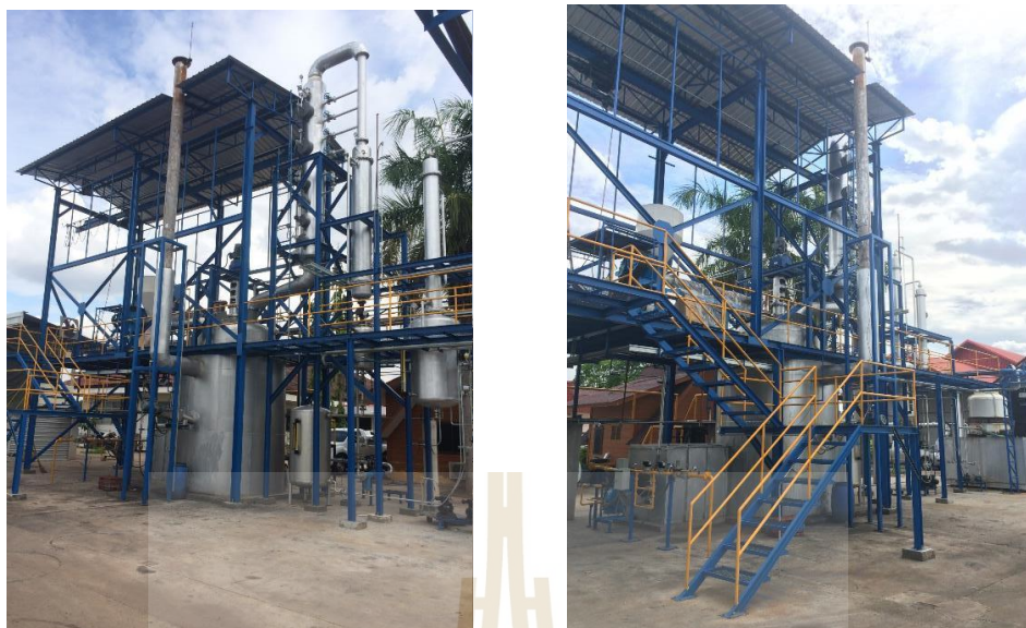
รูปที่ 3.4 การผลิตน้ำมันขยะพลาสติกผสมด้วยกระบวนการไพโรไลซิส ศูนย์ความเป็นเลิศทางด้าน ชีวมวล มหาวิทยาลัยเทคโนโลยีสุรนารี
