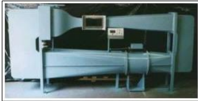
รูปที่ 2.10 อุโมงค์ลมความเร็วต่ำกว่าเสียงแบบปิด (NASA, 2022)
