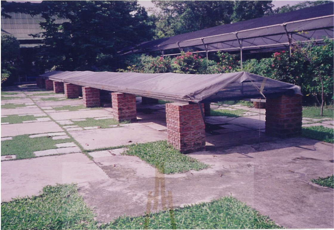
ภาพที่ 15. เครื่องอบแห้งพลังงานแสงอาทิตย์ชนิดอุโมงค์ลม.
