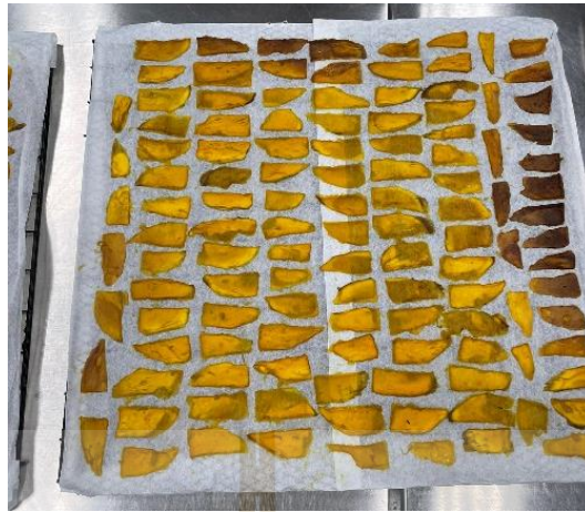
รูปที่ 4.5 ลักษณะรอยไหม้ของมะม่วงอบแห้งเมื่อใช้รังสีอินฟราเรด
