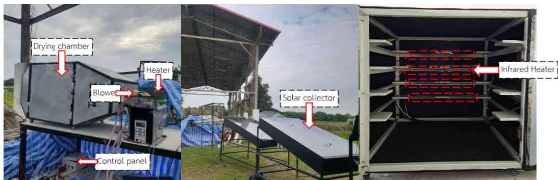
รูปที่ 4.1 เครื่องอบแห้งแหล่งความร้อนร่วมจากรังสีอินฟราเรดและพลังงานแสงอาทิตย์
