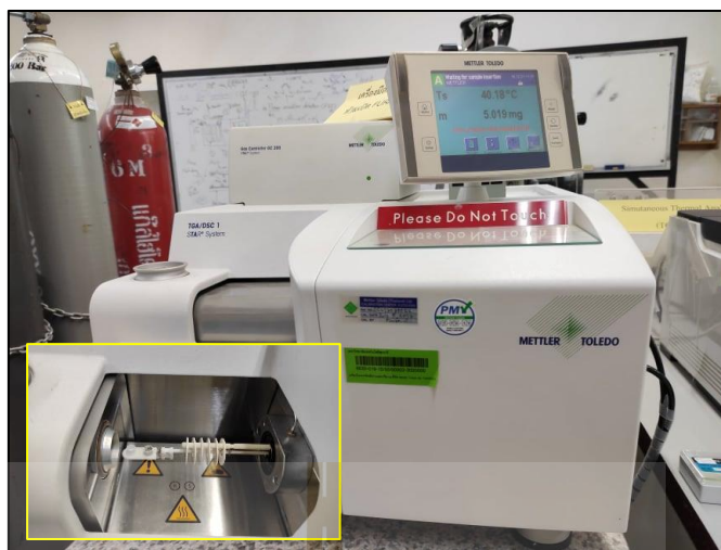
รูปที่ 5.7 การชั่งน้ำหนักแผ่นกรองก่อน-หลังการเก็บตัวอย่างเขม่า
