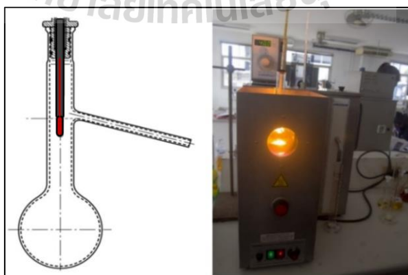
รูปที่ 4.11 เครื่องมือและอุปกรณ์ที่ใช้ในการวิเคราะห์อุณหภูมิการกลั่น
