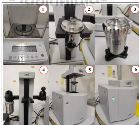
รูปที่ 4.10 เครื่องมือวิเคราะห์ค่าความร้อนเชื้อเพลิง
