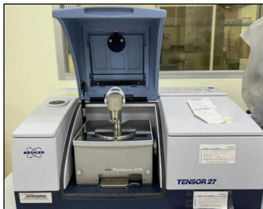
รูปที่ 4.5 เครื่องฟูเรียร์ทรานส์ฟอร์ม-อินฟราเรดสเปกโตรสโคปี (FT-IR)
