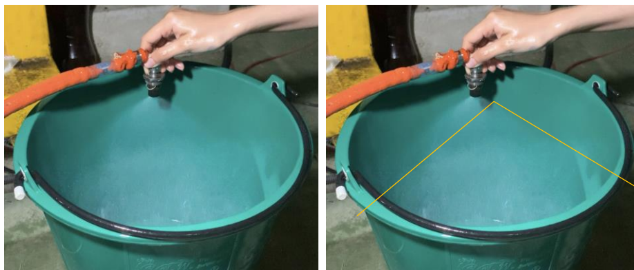
รูปที่ 3.19 แสดงการฉีดเชื้อเพลิงด้วยระบบควบคุมเชื้อเพลิงใหม่
