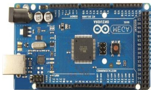
รูปที่ 2.37 Arduino Mega 2560 Board ที่ใช้ในงานวิจัย
