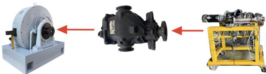
รูปที่ 3.14 แผนการติดตั้งเครื่องยนต์เข้ากับไดนาโมมิเตอร์
