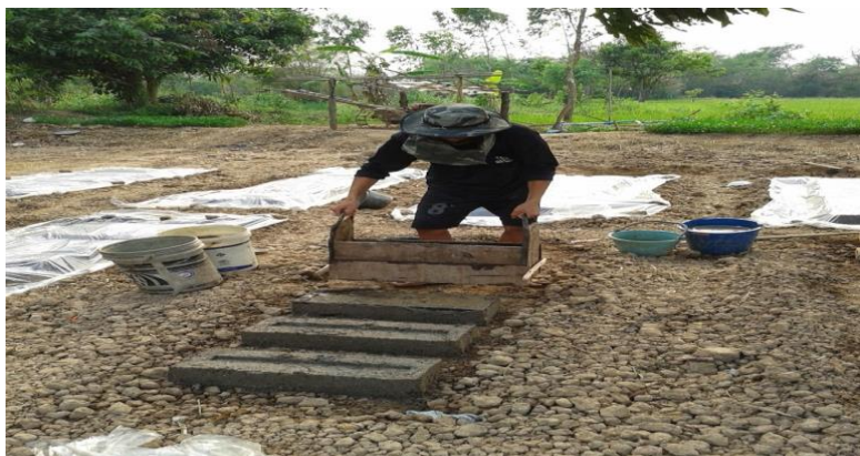
รูปที่ 2.23 นำกากมันมาเหยียบใส่ในแบบพิมพ์ให้แน่น
