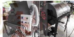
รูปที่ 2 ต้นแบบเครื่องอบกากมันสำปะหลังสำหรับภาค ครัวเรือน
