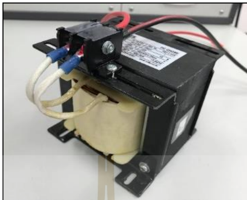
รูปที่ 6.12 ตัวเหนี่ยวนำของวงจรแปลงผันแบบบัค
