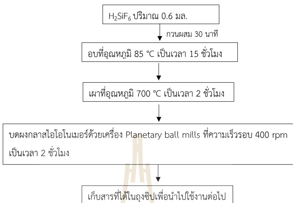
รูปที่ 3.1 แผนภาพกระบวนการเตรียมกลาสไอโอโนเมอร์ซีเมนต์ด้วยวิธีโซลเจล
