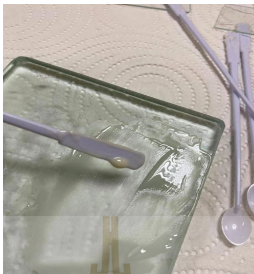
รูปที่ 3.5 การเตรียมกระจกไอโอโนเมอร์ซีเมนต์ด้วยวิธีการผสมด้วยมือ
