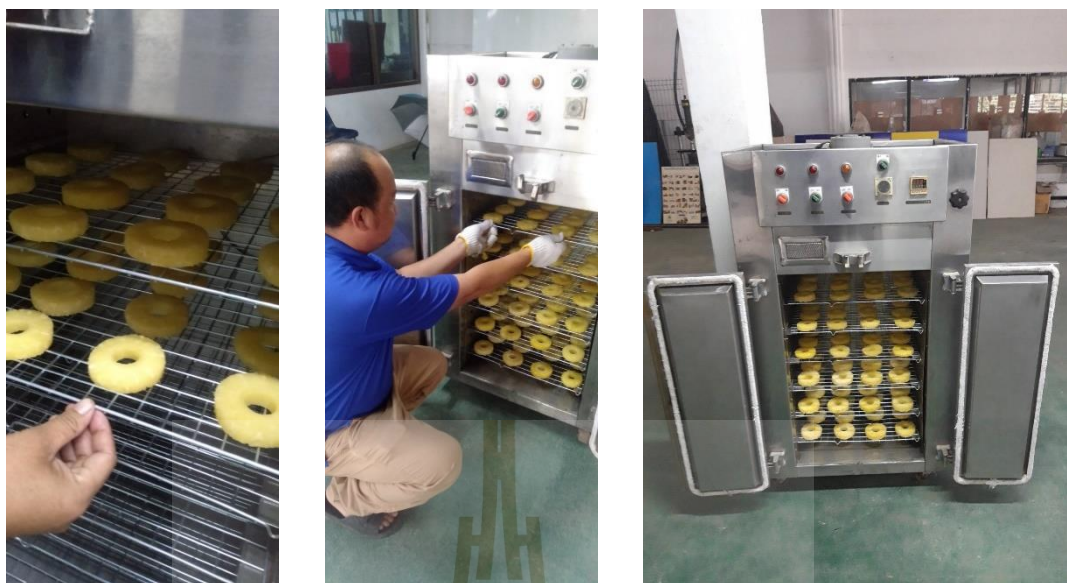
รูปที่ 3.27 การวางชั้นสับปะรดเข้าวางในชั้นตู้อบแห้ง
