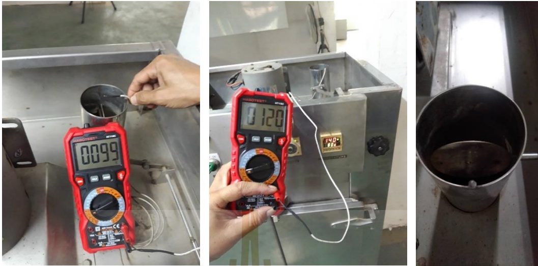
รูปที่ 3.29 การวัดอุณหภูมิของลมร้อนที่ช่องทางออกของตู้อบแห้ง
