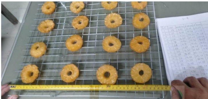
รูปที่ 3.13 ความยาวของตะแกรงชั้นวางสับปรดในตู้อบ 45 เซนติเมตร
