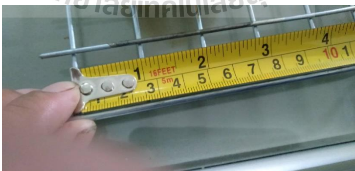
รูปที่ 3.15 ระยะห่างของตะแกรงชั้นวางสับปรดในตู้อบในแต่ละช่อง 26 x 26 มิลลิเมตร
