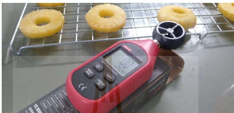
รูปที่ 3.16 อุปกรณ์วัดความเร็วลม
