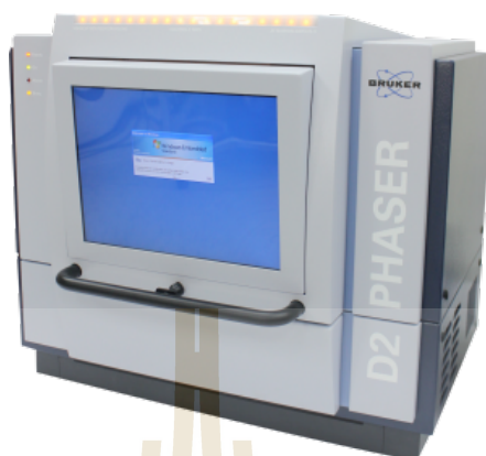
รูปที่ 3.3 เครื่องมือวิเคราะห์การเลี้ยวเบนของรังสีเอกซ์ (X-ray Diffractometer : XRD)
