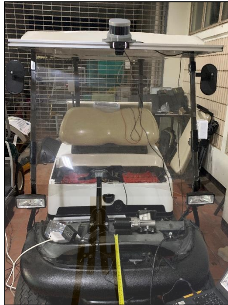
รูปที่ 3.2 การติดตั้งเซนเซอร์ด้านหน้ารถกอล์ฟไฟฟ้า
