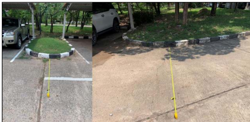
รูปที่ 3.9 แสดงขั้นตอนการวัดตำแหน่งเพื่อติดเทปจุดอ้างอิง
