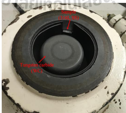
รูปที่ 3.4 การแปรรูปพลาสติกอย่างรุนแรงด้วยวิธีการบดด้วยแรงสั่น
