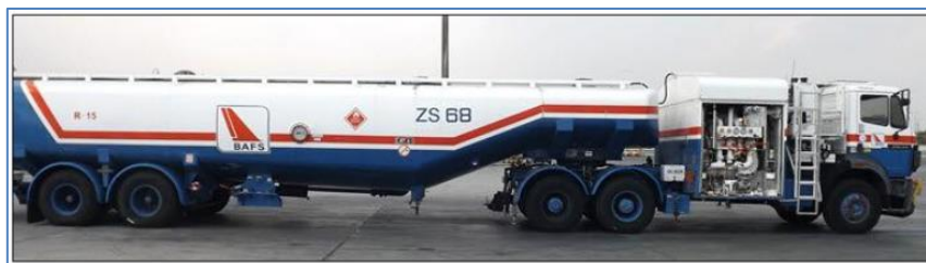
ภาพที่ 2.3 รถเติมเชื้อเพลิงอากาศยานแบบ Refueler
