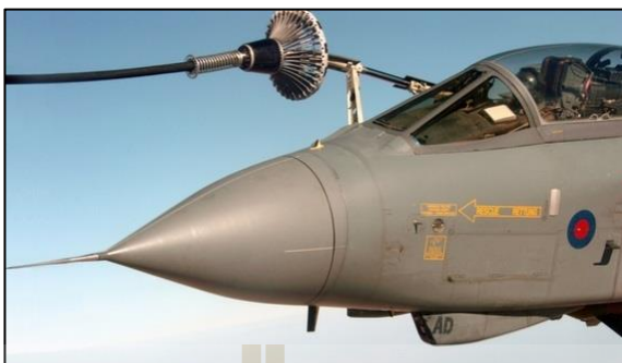
ภาพที่ 2.5 การเติมเชื้อเพลิงอากาศยานในอากาศแบบ Probe and Drogue System
