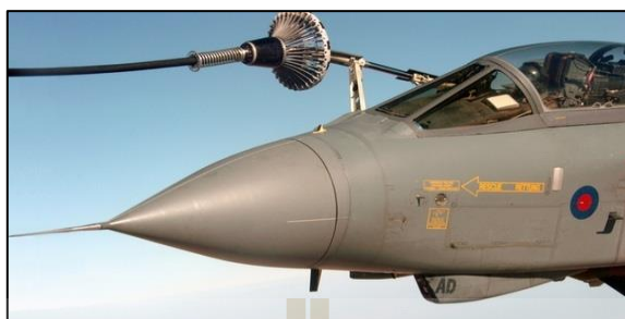
ภาพที่ 5.7 การเติมเชื้อเพลิงอากาศยานในอากาศแบบ Probe and Drogue System
