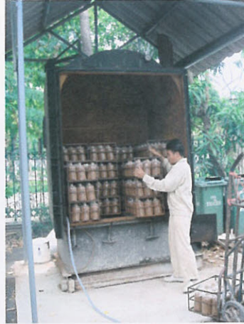
ภาพที่ 42 นำก้อนเชื้อที่บรรจุเสร็จแล้วเข้าตู้ตั้งหม่าเชื้อ
