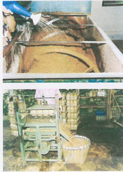
ภาพที่ 61 เครื่องคลุกส่วนผสม และเครื่องแคะซี่เดี่ยวออกจากขวด
